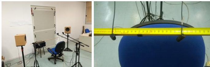
Σχήμα 4.1 Πειραματική διάταξη συστήματος ακυρωτικής παρεμβολής και μετρητική μέθοδος για την μέτρηση της απόδοσης για διάφορες μετακινήσεις.
