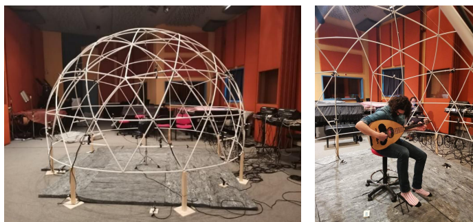
Σχήμα 1.1 Η διάταξη του ημισφαιρικού κλωβού μέσω της οποίας διενεργήθηκαν οι ηχογραφήσεις.
